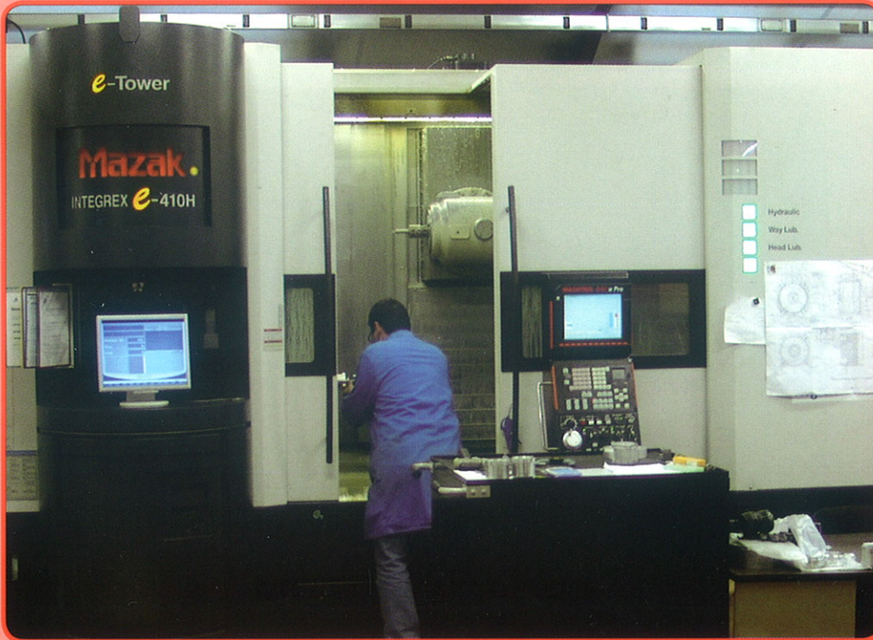
Centre multi fonctions e410 HS en cours de réglage
